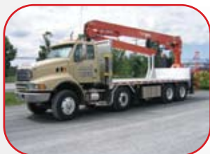
Plate-forme pour coffreur
